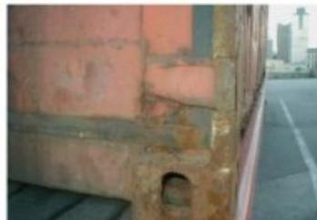
El contenedor con deficiencias o en mal estado es más vulnerable a reparaciones o modificaciones para el ocultamiento y contrabando. Pone en peligro la carga, a los operadores y a la cadena logística.
