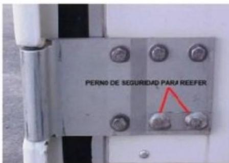
Bisagra con soldadura continua, no se tiene acceso a los tornillos.
