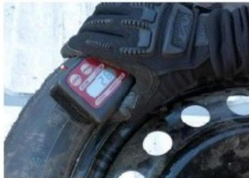
Los medidores de densidad Buster utilizan un emisor de radiación de rayos gamma de baja intensidad y un detector de centelleo para escanear vehículos u objetos en busca de contrabando oculto.
